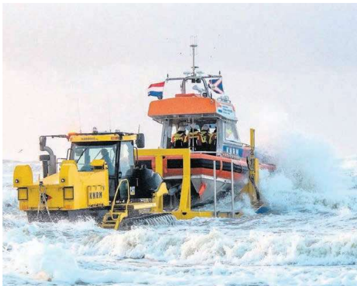
De KNRM motorstrandreddingsboot van Katwijk wordt men een waterdichte tractor op een speciale wagen in zee gereden om dan vanaf de kust te varen naar het noodgeval.
